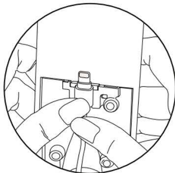
**Schritt 4:** Drücken Sie das Kabel in die Führung unterhalb der Kabelhalterung.
