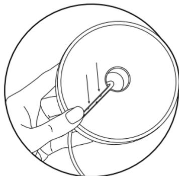
**Schritt 6:** Drücken Sie das Kabel in die Führung unterhalb der Aluminiumbasis.
