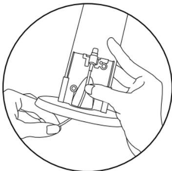
**Schritt 5:** Führen Sie das Kabel durch die Öffnung im Fuß der Aluminiumbasis.
